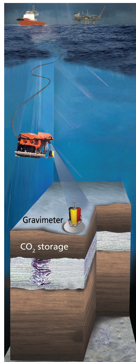
Fjernstyrte undervannskoster leser av tyngdekraftmålerne. Ill: Statoil
